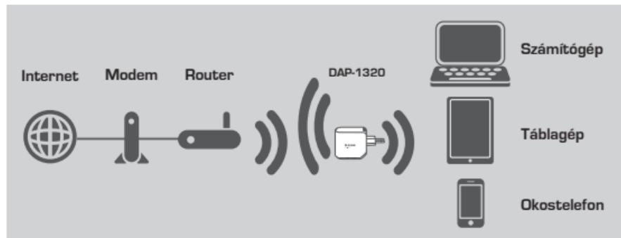
Bővítsé egy másik hozzáférési pont vagy vezeték nélküli router vezeték nélküli lefedettségét.
