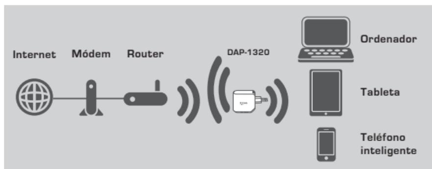
Ampliar la cobertura inalámbrica de otro punto de acceso o router inalámbrico.
