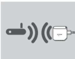
Veuillez attendre jusqu'à deux minutes jusqu'à la fin du processus de connexion. Le voyant reste allumé en vert lorsque le DAP-1320 s'est connecté avec succès au routeur ou au PA sans fil.
