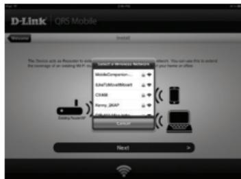
Otwórz aplikację QRS Mobile, wyświetli się Kreator instalacji. Kliknij Start, aby rozpocząć instalację. Urządzenie DAP-1320 najpierw wyszuka sieci bezprzewodowe udostępniane przez pobliskie routery bezprzewodowe lub punkty dostępu. Wybierz sieć bezprzewodową, której zasięg chcesz powiększyć, a następnie – jeśli to konieczne – podaj hasło.
