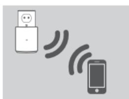
Om indikationsljuset lyser med fast gult ljus efter anslutningsproceduren har avslutats, har DAP-1320 etablerat en anslutning med dålig kvalitet. För att förbättra anslutningens kvalitet ska DAP-1320 flyttas till ett vägguttag som är närmare den trådlösa källroutern eller AP-enheten.
