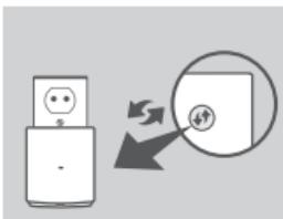
Vtaknite DAP-1320 v stensko vtičnico in počakajte dokler napajalna LED ne utripa rumeno. Pritisnite gumb WPS na izvirnem brezžičnem usmerjevalniku ali AP-ju in nato pritisnite WPS na DAP-1320. LED lučka bo začela utripati zeleno.
