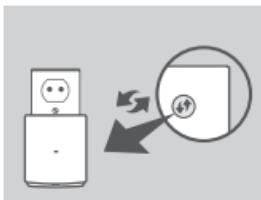
Zapojte zařízení DAP-1320 do elektrické zásuvky a počkejte, než se žlutě rozblíká kontrolka napájení. Stiskněte tlačítko WPS na bezdrátovém směrovači nebo přístupovém bodu a pak podržte stisknuté tlačítko WPS na zařízení DAP-1320. Zelená kontrolka začne blikat.
