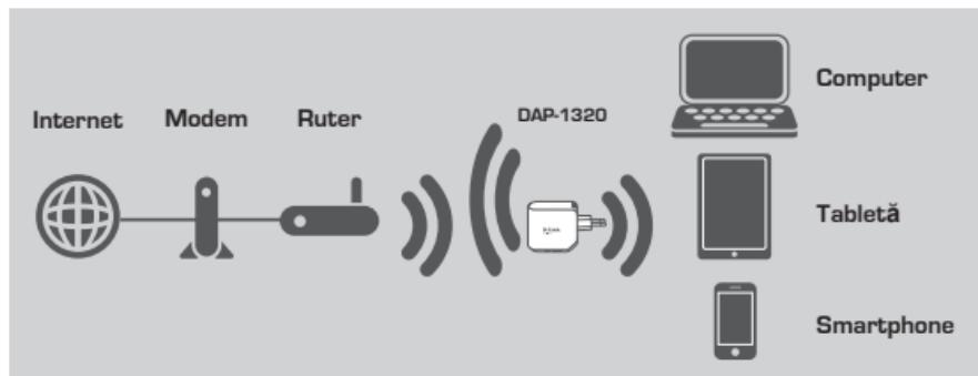
Extindeți acoperirea fără fir a unui alt AP sau ruter fără fir.
