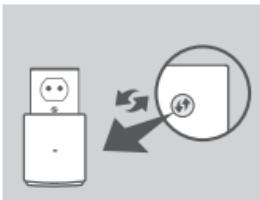
Podłącz urządzenie DAP-1320 do gniazdka sieci elektrycznej i poczekaj, aż dioda LED zacznie migać na pomarańczowo. Naciśnij przycisk WPS na głównym routerze bezprzewodowym lub punkcie dostępowym AP, a następnie naciśnij przycisk WPS na urządzeniu DAP-1320. Dioda LED zacznie migać na zielono.
