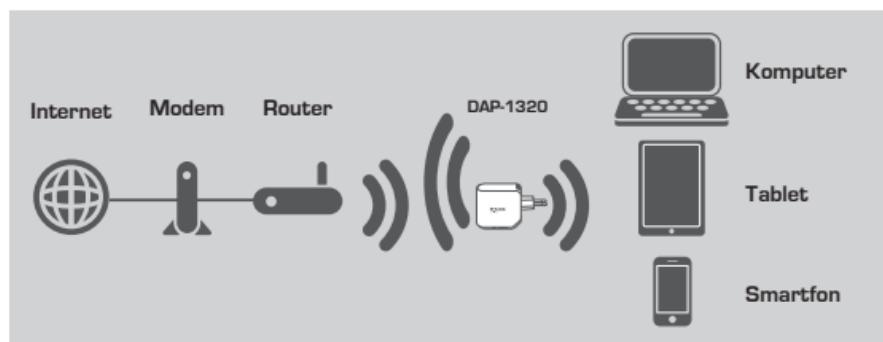
Powiększ zasięg połączenia bezprzewodowego dla kolejnego punktu dostępu lub routera bezprzewodowego.
