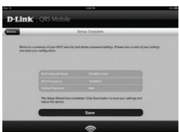
Se mostrará a continuación un resumen de los parámetros de red. Si está conforme, haga clic en Guardar y el asistente de configuración reiniciará el DAP-1320 para que los nuevos parámetros surtan efecto. Ahora, el DAP-1320 puede ampliar la red Wi-Fi para usted.
