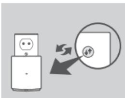
Ukopčajte DAP-1320 u zidnu utičnicu i pričekajte da LED indikator počne bljeskati narančasto. Pritisnite tipku WPS na izvornom bežičnom usmjerniku ili AP-u, a zatim pritisnite tipku WPS na uređaju DAP-1320. LED indikator počet će bljeskati zeleno.
