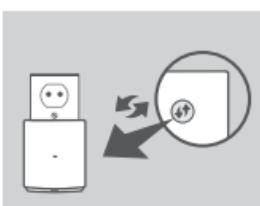
Collegare il dispositivo DAP-1320 a una presa a muro e attendere finché il LED Power sia acceso e di colore giallo. Premere il pulsante WPS del router wireless sorgente o AP, quindi premere il pulsante WPS del dap-1320. Il LED inizia a lampeggiare in verde.
