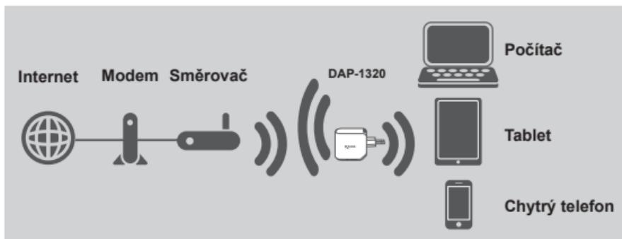
Rozšiřte bezdrátové pokrytí dalšího přístupového bodu nebo bezdrátového routeru.
