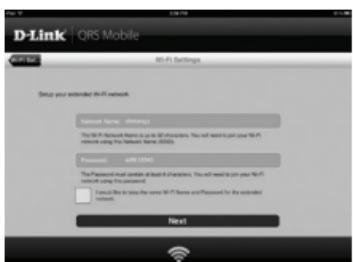
Puede mantener el nombre de red (SSID) y la contraseña actuales para la red Wi-Fi ampliada o introducir un nuevo nombre de red (SSID) y contraseña. A continuación, puede elegir crear una contraseña de administrador para acceder a la utilidad de configuración basada en la web del DAP-1320. Pulse **Siguiente** para continuar.
