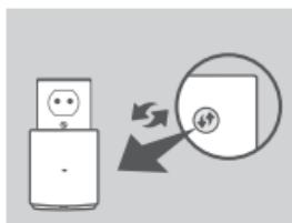
Csatlakoztassa a DAP-1320-at egy fali aljzatba, és várjon, amíg a jelzőfény el nem kezd sárgán villogni. Nyomja meg a WPS gombot a forrás vezeték nélküli routeren vagy hozzáférési ponton, majd nyomja meg a WPS gombot a DAP-1320 eszközön. A jelzőfény elkezd zölden villogni.
