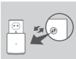
Ligue o DAP-1320 a uma tomada de parede e aguarde até que o LED de alimentação pisque a âmbar. Pressione o botão WPS no router sem fios fonte ou PA e pressione o botão WPS no dap-1320. O LED começa a piscar a verde.
