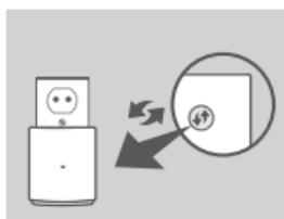
Anslut DAP-1320 till vägguttaget och vänta tills lysdioden för strömförsörjning tänds blinkar gult. Tryck på WPS-knappen på källans trådlösa router eller AP, och tryck därefter på WPS-knappen på dap-1320. Lysdioden börjar blinka grönt.
