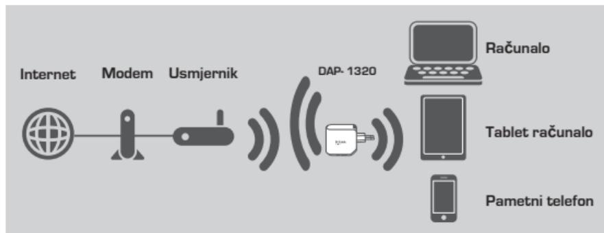
Proširuje bežični domet druge pristupne točke ili bežičnog usmjernika.
