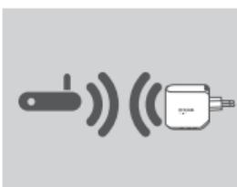
Do zakończenia procesu pozostało jeszcze około dwóch minut. Po nawiązaniu połączenia urządzenia DAP-1320 z routera bezprzewodowym lub punktem dostępu dioda LED zacznie świecić na zielono.
