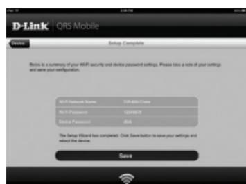
Va fi afișat un rezumat al setărilor rețelei. Când sunteți mulțumit de setări, faceți clic pe Salvare, iar expertul pentru configurare va reporni dispozitivul DAP-1320 pentru ca noile setări să fie aplicate. Acum, dispozitivul DAP-1320 poate extinde rețeaua Wi-Fi pentru dvs.
