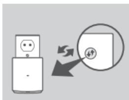
Schließen Sie den DAP-1320 an eine Wandsteckdose an und warten Sie, bis die Betriebsanzeige-LED gelb leuchtet. Drücken Sie auf dem drahtlosen Quellen-Router oder -AP auf die WPS-Taste und drücken Sie dann auf die WPS-Taste des DAP-1320. Die LED beginnt grün zu blinken.
