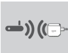
Men vent i op til to minutter på, at processen afsluttes. LED'en skifter til konstant grønt, når DAP-1320 er korrekt tilsluttet den trådløse router eller AP.
