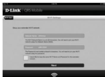
È possibile mantenere il nome di rete (SSID) e la password correnti per la rete Wi-Fi estesa oppure immettere un nuovo nome di rete e una nuova password. È quindi possibile scegliere di creare una password dell'amministratore per accedere all'utilità di configurazione basata sul Web del dispositivo DAP-1320. Toccare **Avanti** per continuare.
