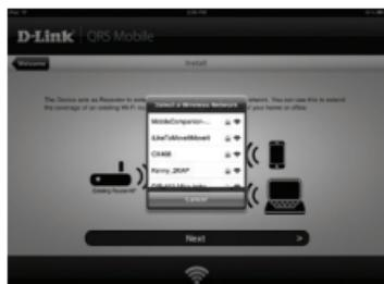
Otevřete aplikaci QRS Mobile, zobrazí se průvodce nastavením. Začněte kliknutím na Start. Zařízení DAP-1320 nejprve vyhledá bezdrátové sítě blízkých bezdrátových směrovačů a přístupových bodů. Vyberte bezdrátovou síť, jejíž dosah chcete rozšířit, a v případě potřeby zadejte heslo.
