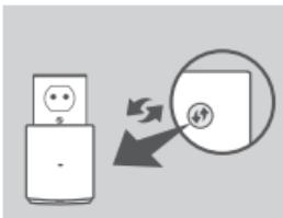
Stik DAP-1320 i en stikkontakt, og vent, til spændings-LED'en blinker gult. Tryk på WPS-knappen på den trådløse router eller AP; tryk på WPS-knappen på den trådløse router eller adgangspunkt (AP), tryk derefter på WPS-knappen på DAP-1320. LED'en begynder at blinke grønt.
