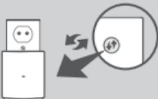
Conectați dispozitivul DAP-1320 la o priză de perete și așteptați până când LED-ul de alimentare devine galben. Apăsați pe butonul WPS de pe routerul wireless sau punctul de acces sursă, apoi apăsați pe butonul WPS de pe dispozitivul DAP-1320. LED-ul va începe să se aprindă intermitent (verde).
