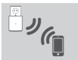
Leuchtet die LED durchgehend gelb, nachdem der Verbindungsvorgang abgeschlossen wurde, kennzeichnet das, dass die DAP-1320 eine Verbindung minderer Qualität hergestellt hat. Um die Verbindungsqualität zu verbessern, sollte der DAP-1320 an einer Wandsteckdose angeschlossen werden, die näher am drahtlosen Quellen-Router oder AP ist.
