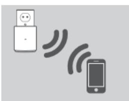
Jeśli po nawiązaniu połączenia dioda LED urządzenia DAP-1320 świeci się na pomarańczowo, oznacza to, że jakość połączenia jest niska. Aby uzyskać lepszą jakość, urządzenie DAP-1320 należy podłączyć do gniazdaściennego w pobliżu routera sieci Wi-Fi lub punktu dostępowego.
