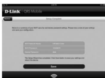
Wyświetlona zostanie lista ustawień sieciowych. Po dokonaniu wszelkich wymaganych zmian kliknij opcję Save (Zapisz); Kreator instalacji ponownie uruchomi urządzenie DAP-1320, aby wprowadzić nowe ustawienia. Urządzenie DAP-1320 może teraz poszerzyć zasięg sieci Wi-Fi użytkownika.
