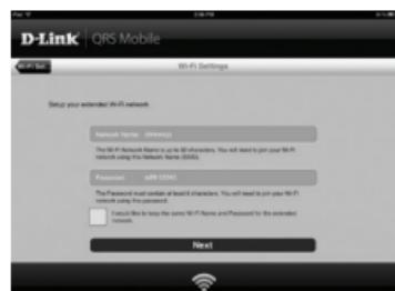
Pode manter o nome da rede atual (SSID) e a palavra-passe para a rede Wi-Fi amplificada, ou introduzir o nome de rede (SSID) e uma palavra-passe novos. Em seguida, pode optar por criar uma palavra-passe de administrador para aceder ao utilitário de configuração baseado na Web DAP-1320. Clique em **Next (Seguinte)** para continuar.
